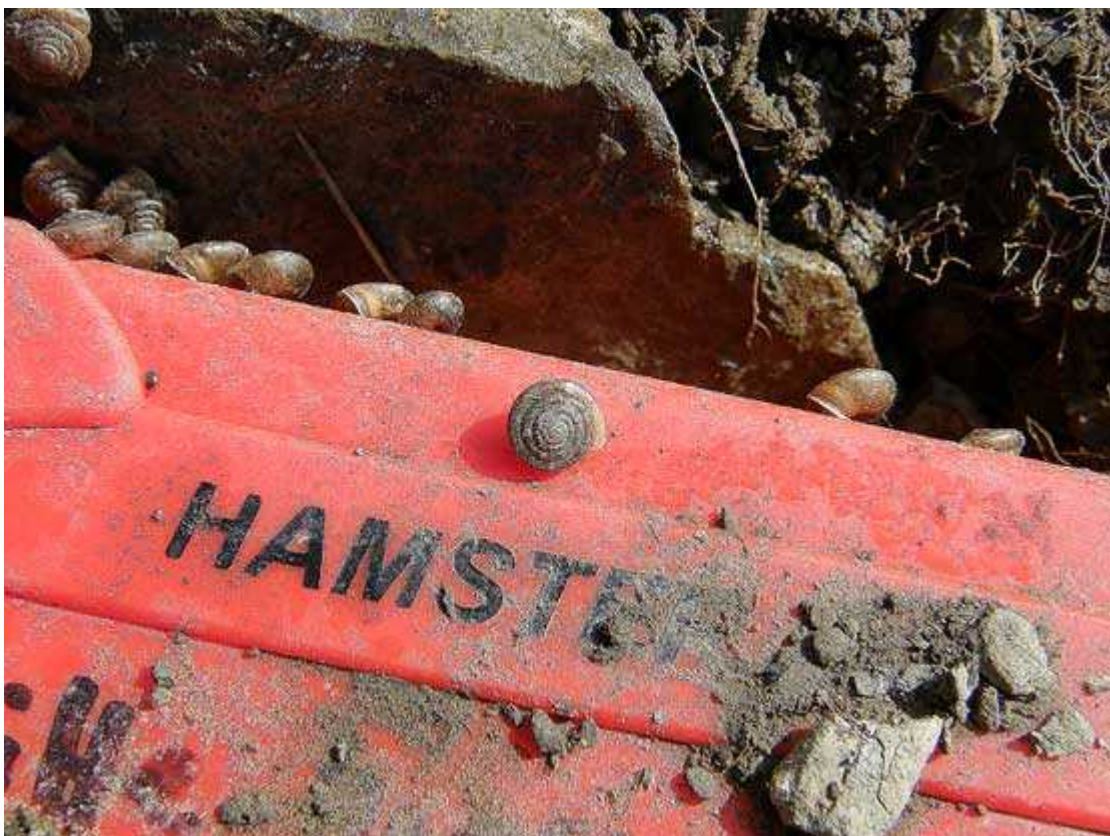
Abbildung 8: Temperatur-Aufzeichnungsgerät Typ Hamster am Standort „Chaiserstuel Südwest". Foto: 15. Oktober 2008.
